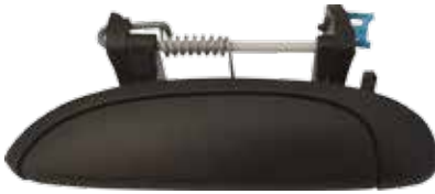
Clio Symbol Kapı Dış Açma Kolu Sol (Eski Model) Clio Symbol Door Exterior Opening Handle Left (Old Model)
