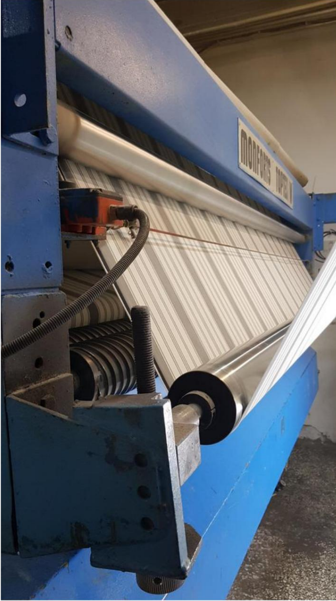
Ek 25 (Acil durdurma kablosu yüklenmiştir.jpg) Denetçi yorumları ve bulguları - Sağlık ve Güvenlik Sayfa 55
