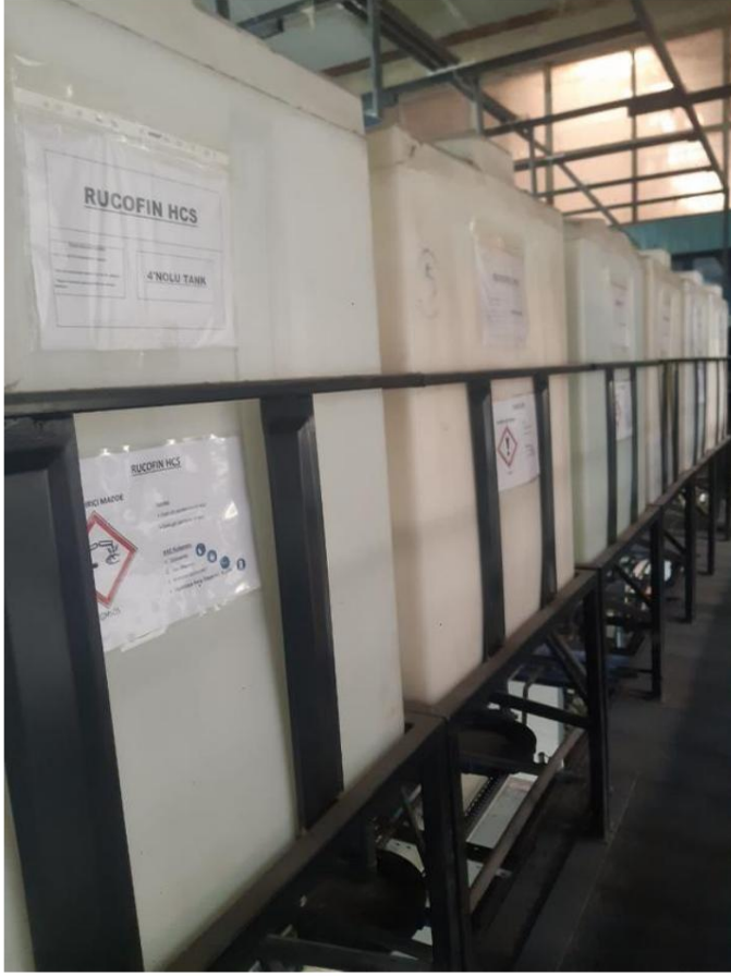
Ek 7 (Ana kimyasal silos.jpg'de ilgili uyarı sembolleriyle işaretlenmiş kimyasallar) Denetçi yorumları ve bulguları - Çevresel Performans Sayfa 30
