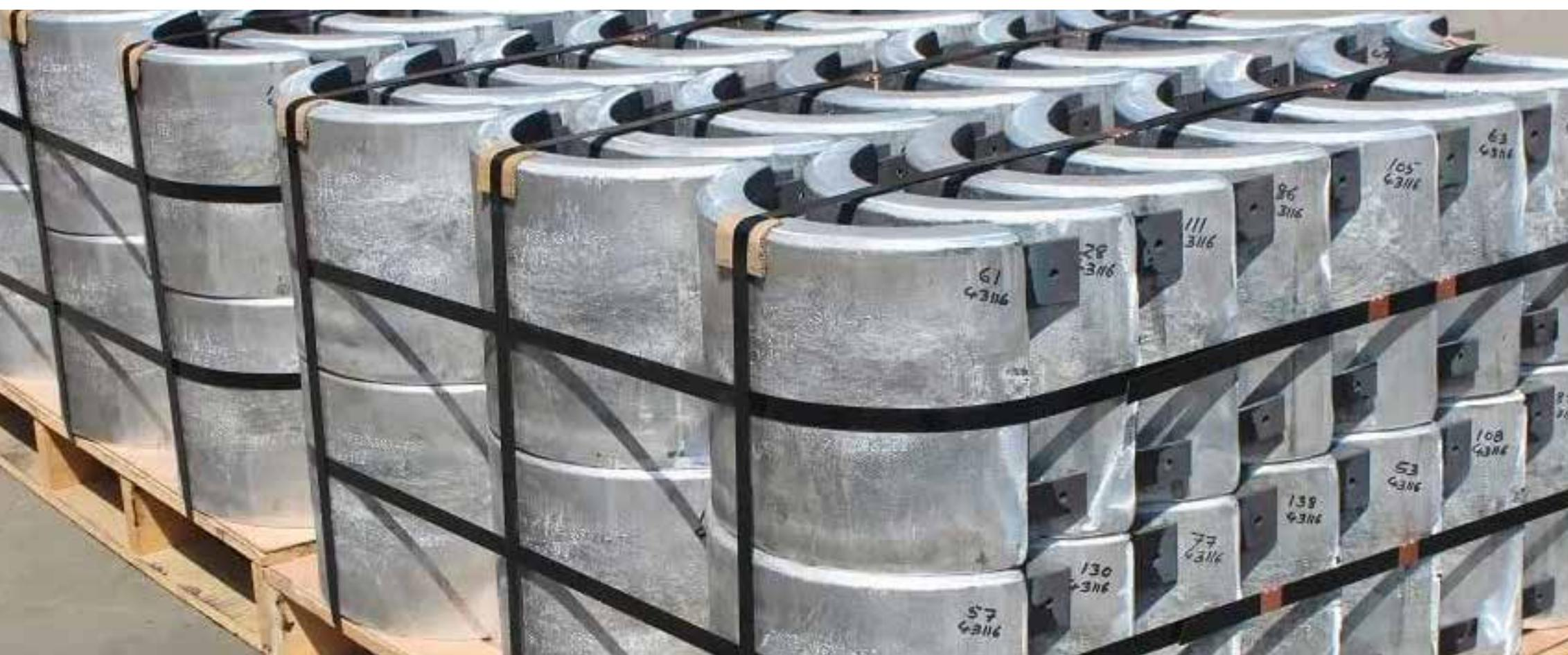
Alüminyum indiyum bilezik anot özellikle katodik koruma için tasarlanmış denizaltı / deniz boru hatları, platform, köprü ayağı, çelik kazık iskele, herhangi bir dairesel çelik yapı vb. kullanılmak için tasarlanmıştır. Bir borunun etrafına sarılı olarak uygulanmaya uygundur. 2 yarımdan oluşan 2 parçadan oluşur. Özel gereksinimlerinize uyacak bir anodun optimize edilmesi konusunda tavsiye almak için lütfen TIGEMER ile iletişime geçin.
